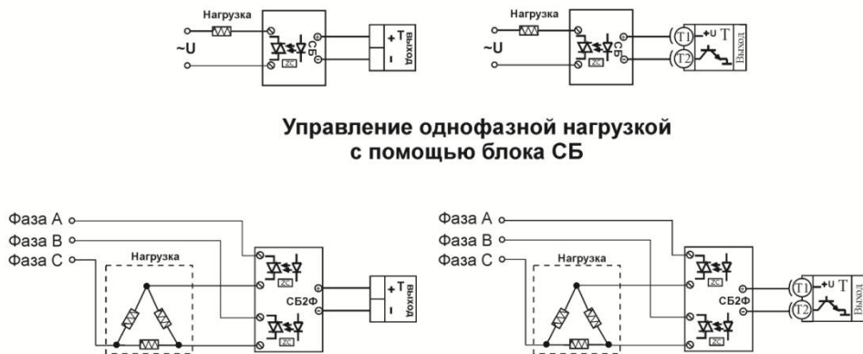
Использование двухфазных силовых блоков для управления трехфазной нагрузкой. Схема подключения «Треугольник»
